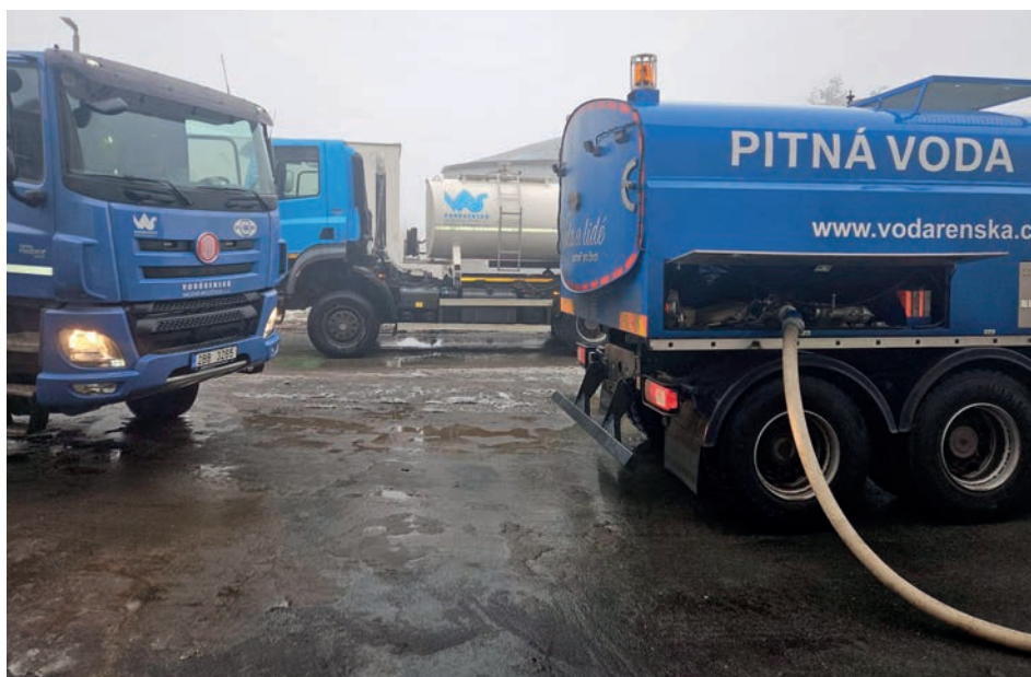
Plnění cisteren náhradního zásobování na ÚV Štítary
